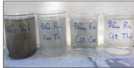
Hình B.1: Nước thải qua các công đoạn xử lý ở 2 mô hình lọc sinh học hiếu khí ngập nước với chiều cao lớp giá thể 0,75 m và 1 m
