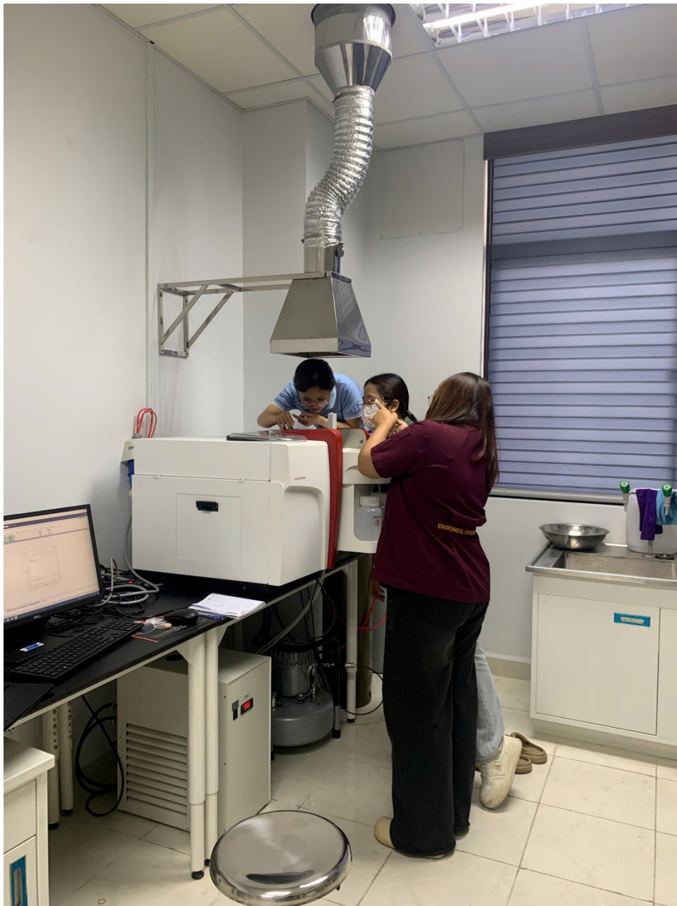
Hướng dẫn vận hành máy quang phổ hấp thụ nguyên tử (AAS) Analytik Jena NovAA 800D
