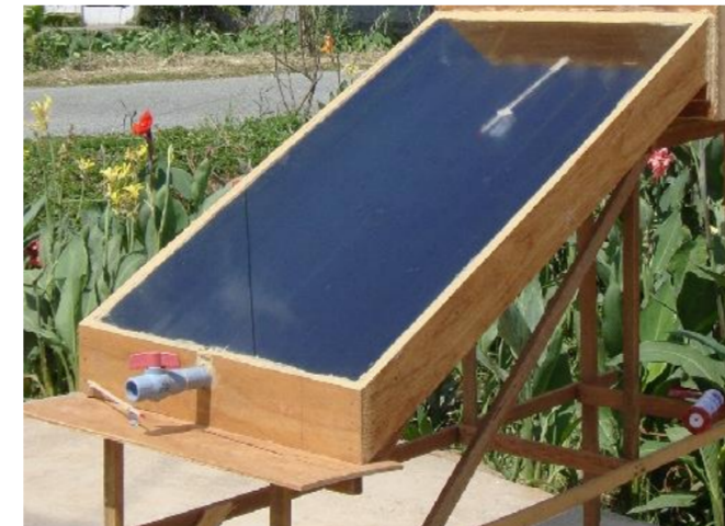
Thiết bị chưng cất nước mặn thành nước ngọt
