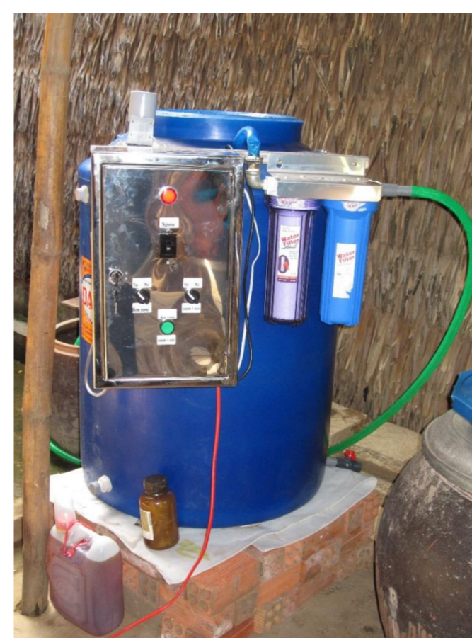
Hệ thống xử lý Asen từ nước ngầm
